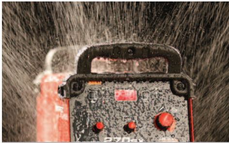
Test IP en el laboratorio de Lincoln
