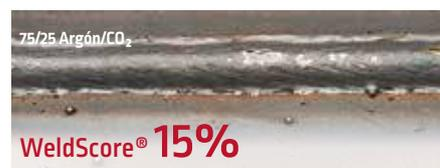
Cordón de soldadura rechazable: Una mezcla de gas incorrecta genera altos niveles de proyecciones.
