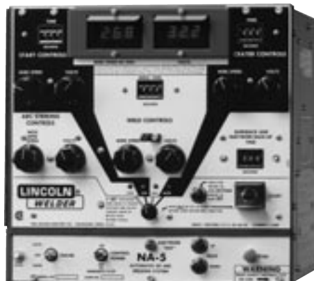
Cofre NA-5 con 2 kits K334 incorporados (inicio de soldadura y relleno de cráter)
